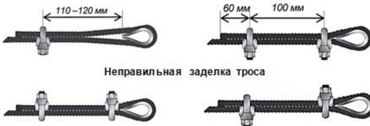
Рисунок 5. Заделка троса
